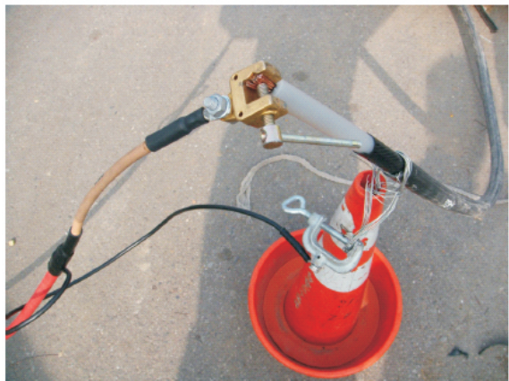
图3 脉冲产生器与故障电缆之连接端
